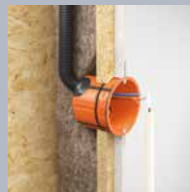
Die neue laschenlose Hohlwanddose O-range ECON® Fix mit Klemmrippen-Befestigung ergänzt das zeit- und kostensparende Programm von KAISER für die luftdichte, energieeffiziente Elektroinstallation nach den Vorgaben des neuen Gebäudeenergiegesetzes und der DIN 18015-5.
