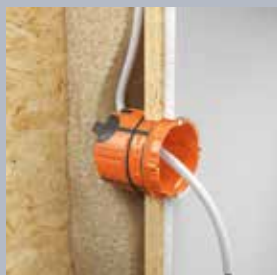
Bei einem mehrschichtigen Wandaufbau mit bereits schon montierter O-range ECON® Fix – wie hier in einer OSB-Platte – kann mithilfe des Ausgleichsrings (Art.-Nr. 9155-61) eine Gipskarton-Platte vorgesetzt werden.
