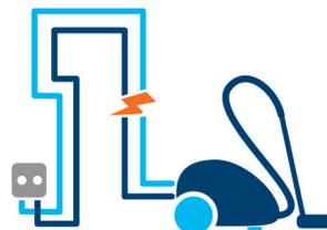
**Parallele Fehlerlichtbögen** können zwischen Außenleiter und Neutraleiter sowie zwischen Außenleiter und Schutzleiter auftreten. Der Fehlerlichtbogen entsteht hier also durch einen Überschlag zwischen zwei Leitern.
